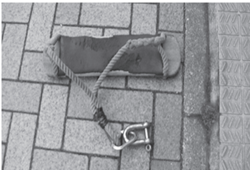
写真は、ビルの窓ガラスクリーニング用ブランコ
